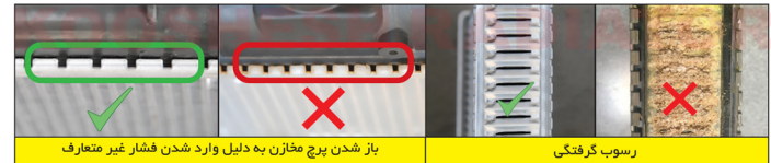
باز شدن پرچ مخازن به دلیل وارد شدن فشار غیر متعارف
